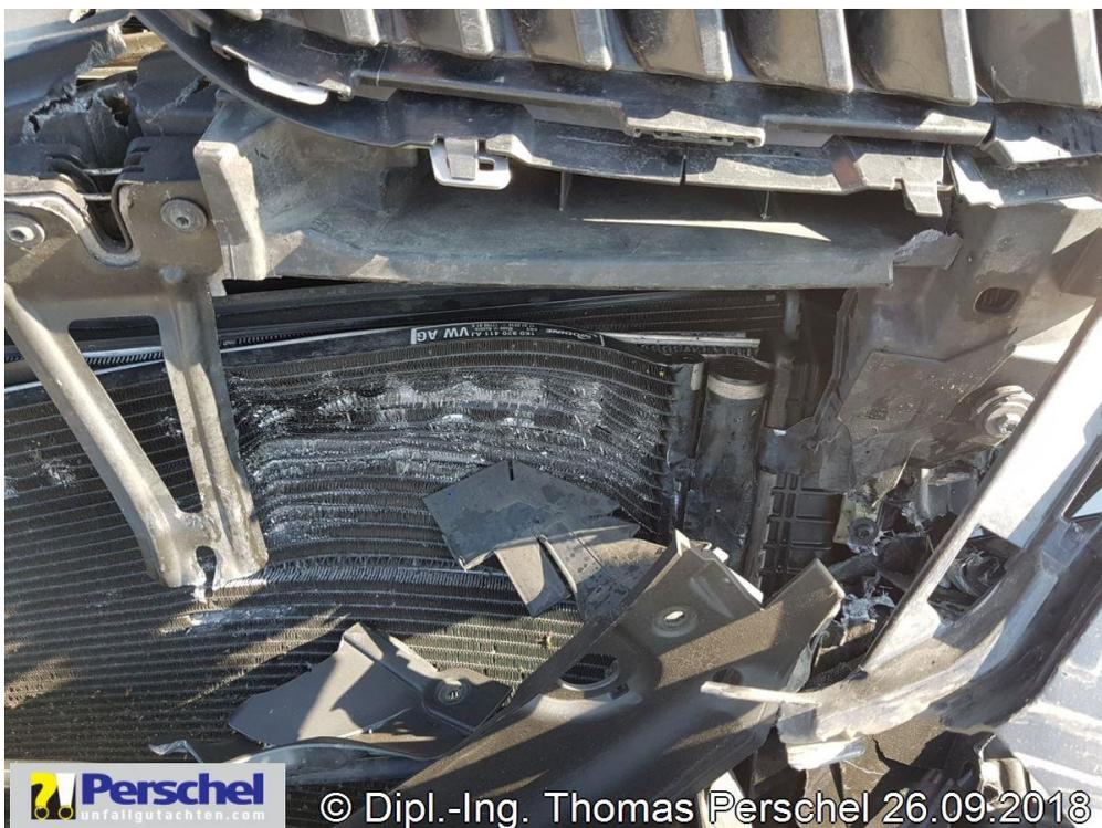
**Bild 6:** Frontmaske gerissen, Kondensator, Ladeluftkühler und Wasserkühler deformiert
