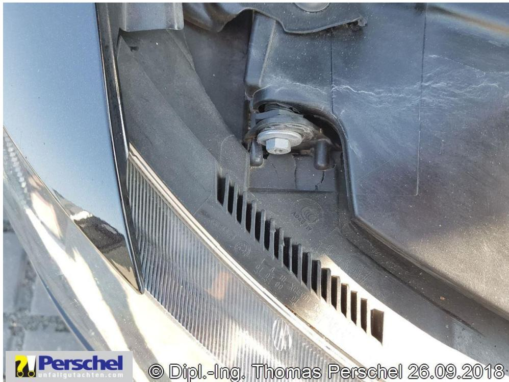
**Bild 8:** Scheinwerfergehäuse r ausgerissen
