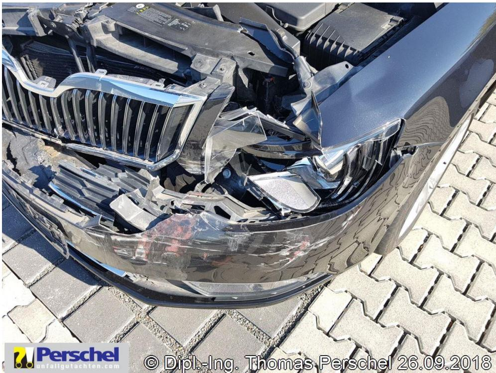
**Bild 4:** Stoßfänger v, Scheinwerfer l, Kotflügel v l, Grill beschädigt
