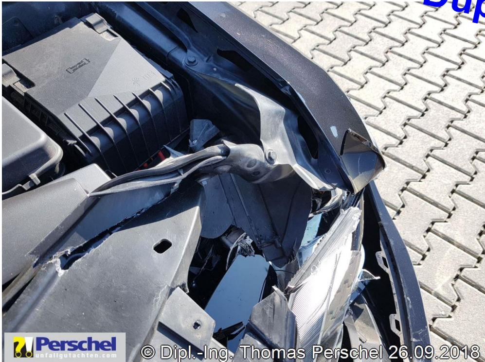
**Bild 5:** Kotflügel v l, Längsträger v l o deformiert
