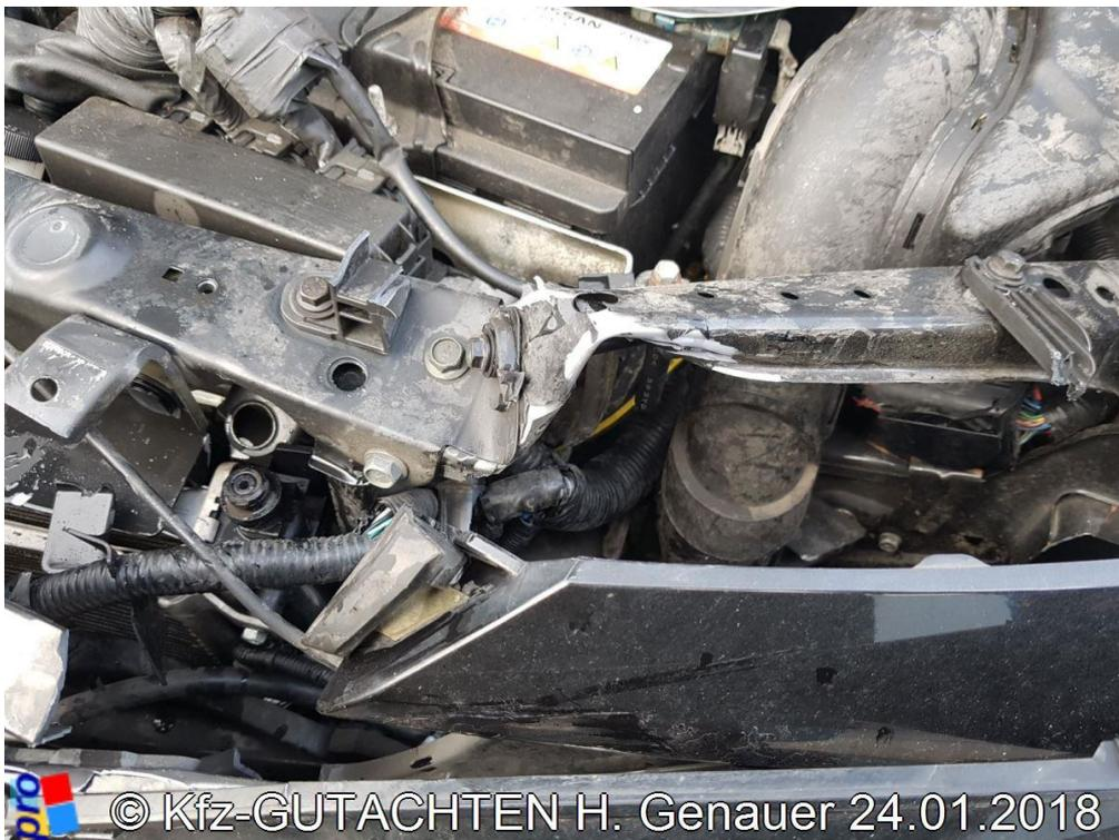
**Bild 8:** Frontblech l stark deformiert
