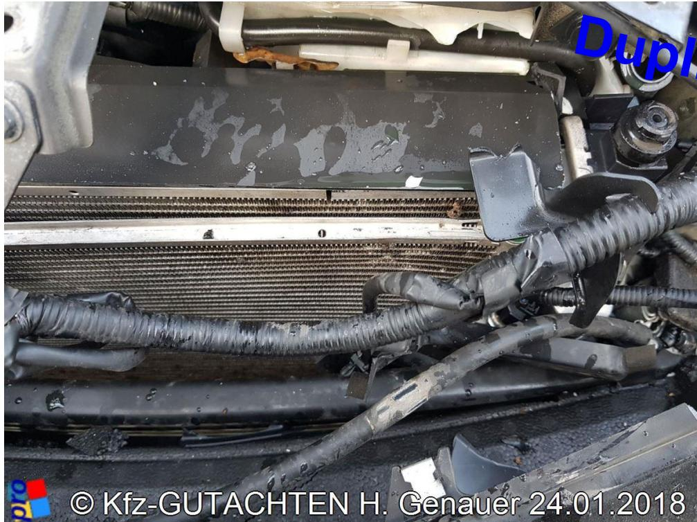
**Bild 9:** Kondensator deformiert, gegen Kühler gedrückt
