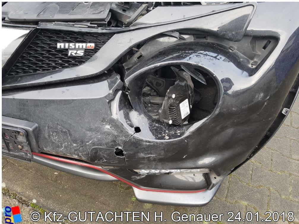
**Bild 4:** Xenon-Scheinwerfer, Stoßfänger, Grill gerissen
