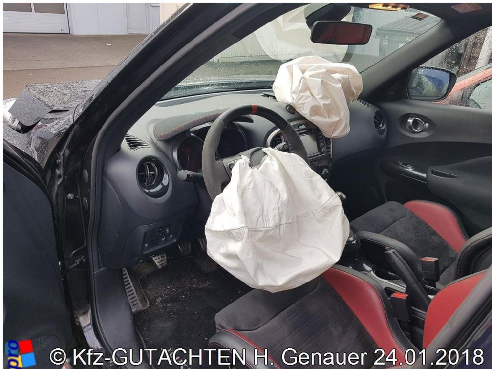
**Bild 10:** Fahrzeuginnenraum, Fahrer- und Beifahrerairbag ausgelöst
