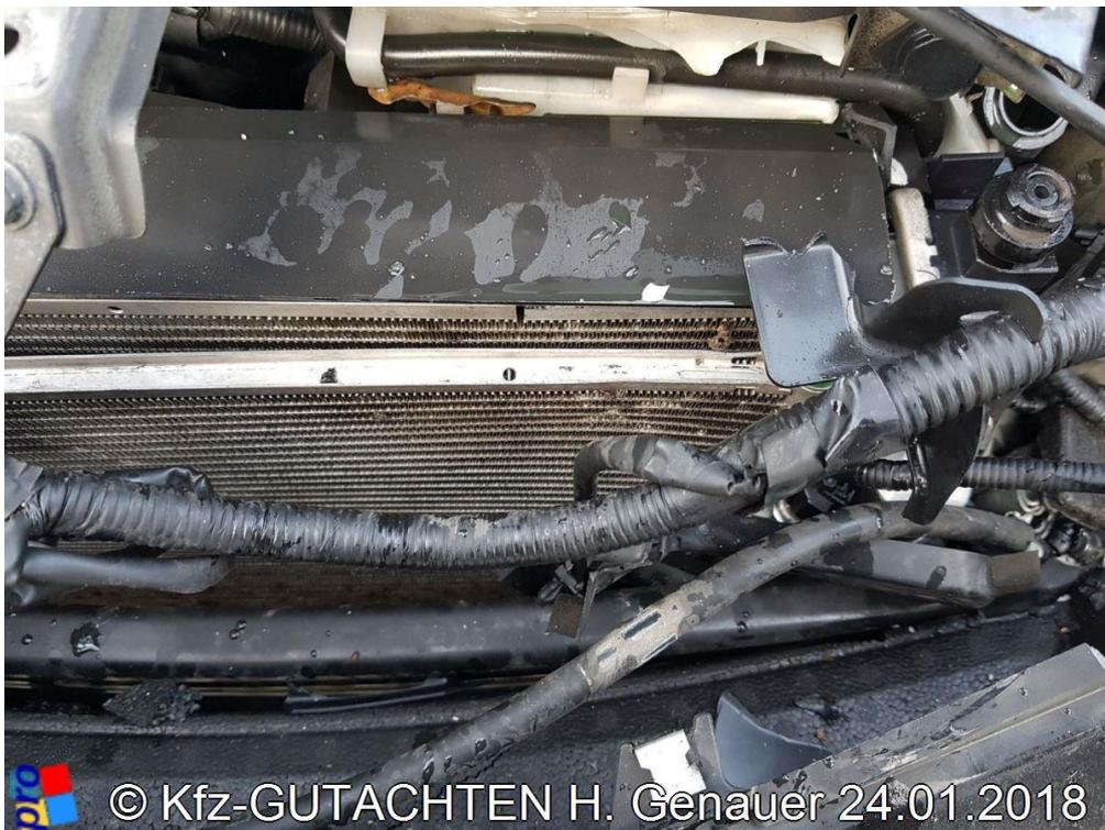
**Bild 8:** Kondensator Klimaanlage und dahinter liegender Kühler eingedrückt
