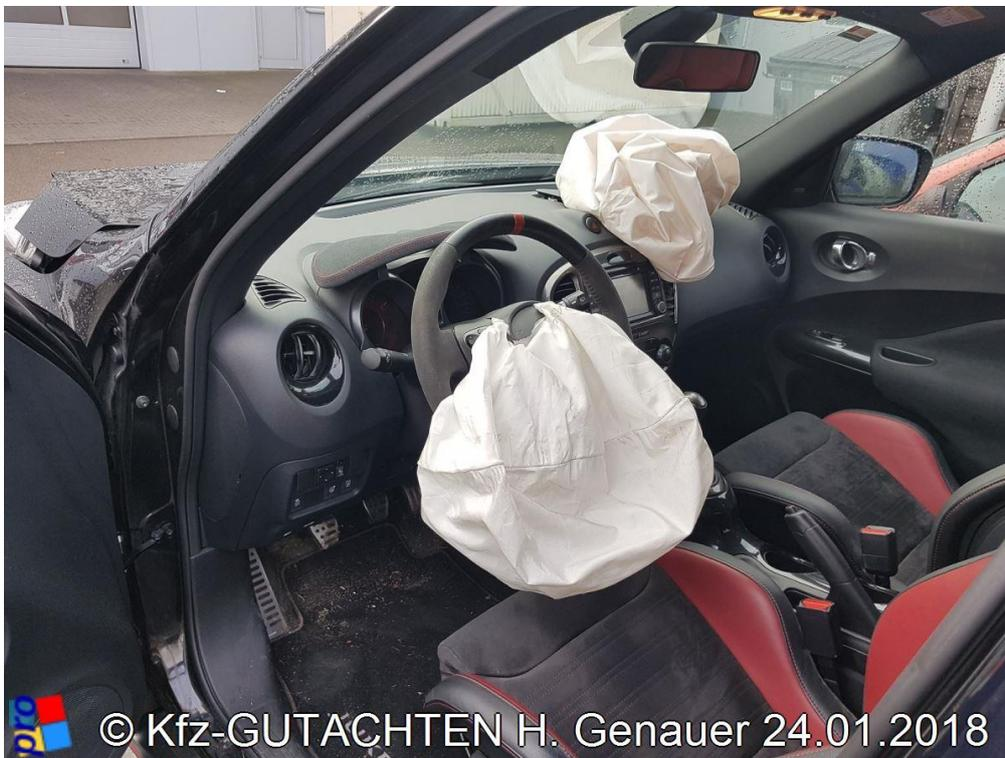
**Bild 12:** Fahrer- und Beifahrerairbag ausgelöst
