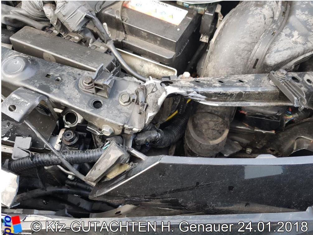
**Bild 7:** Schloßträger und Maskenblech Scheinwerfer I geformiert
