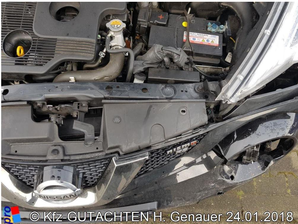
**Bild 4:** Schlossträger deformiert, Scheinwerfer I gerissen
