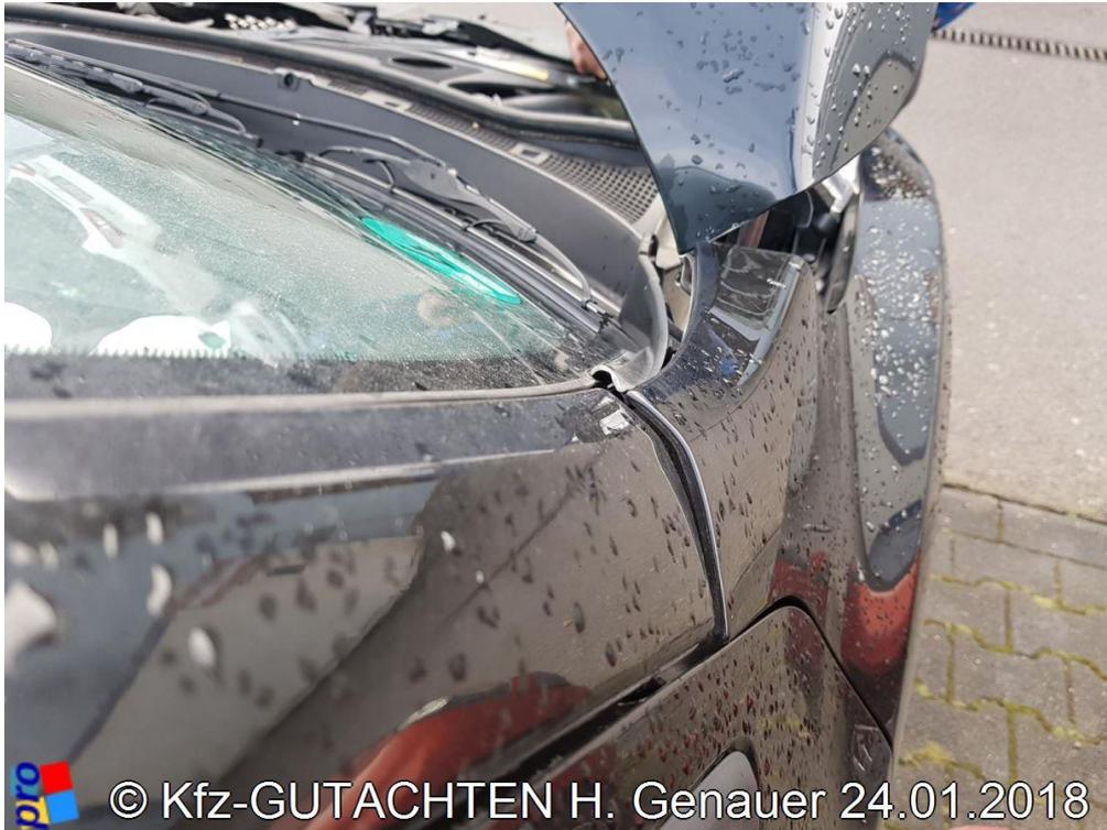
**Bild 11:** Kotflügel v r durch verschobene Motorhaube nach außen gedrückt
