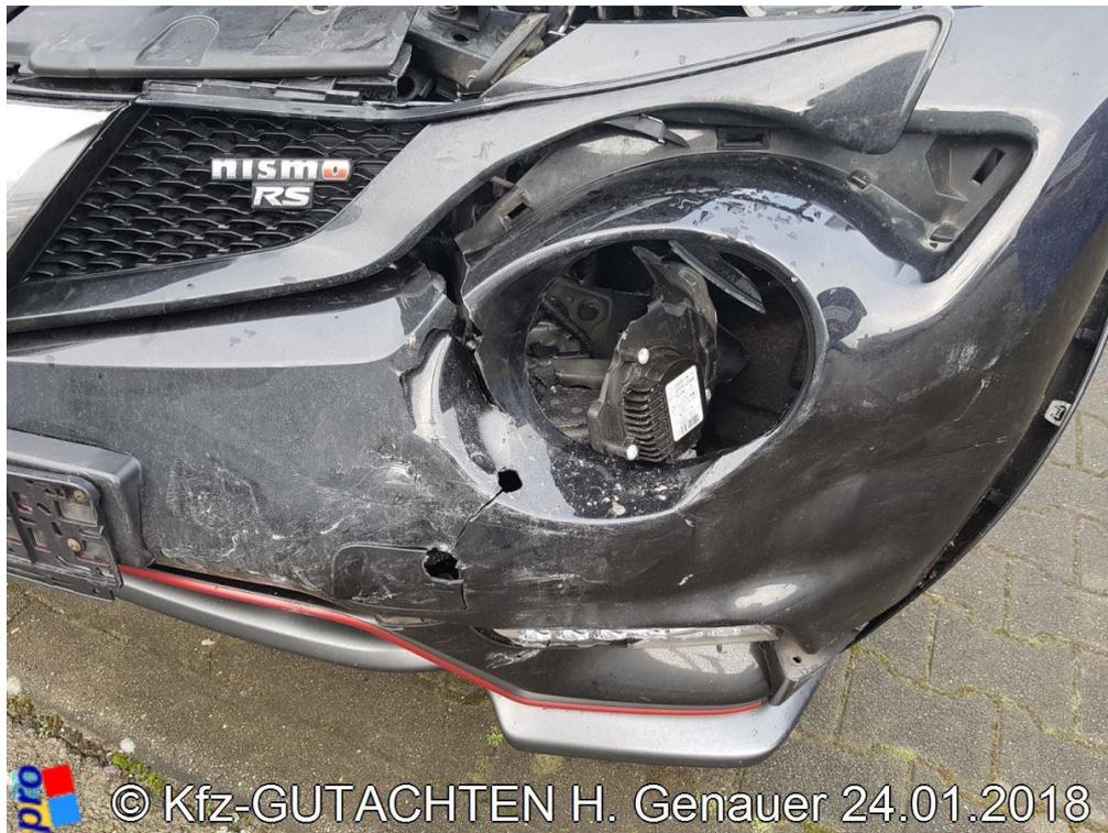
**Bild 5:** Stoßfänger v, Zusatzscheinwerfer I gerissen
