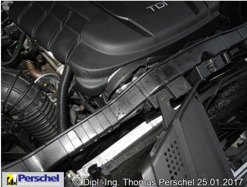
Bild 7: Frontmaske gegen Motorblock gedrückt, Verkleidung Zahnriemen gerissen
