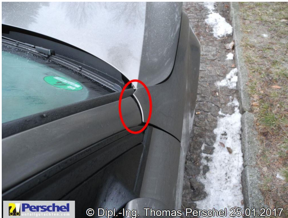
Bild 13: Kotflügel vr nicht mehr in Kontur zur A-Säule
