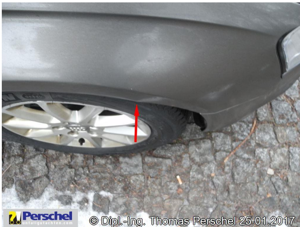
Bild 6: Kotflügel v r gestaucht und ausgeknickt
