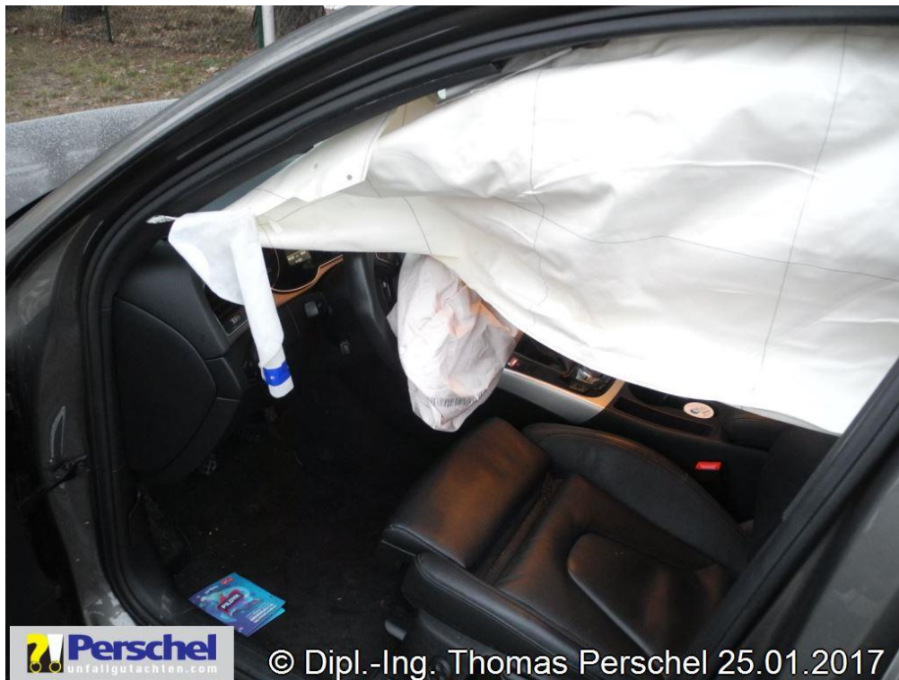
Bild 15: Fahrerairbag und Kopfairbag I ausgelöst
