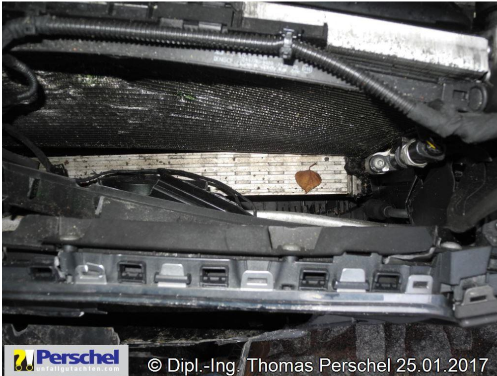
Bild 11: Kondensator, Kühler, Ladeluftkühler deformiert
