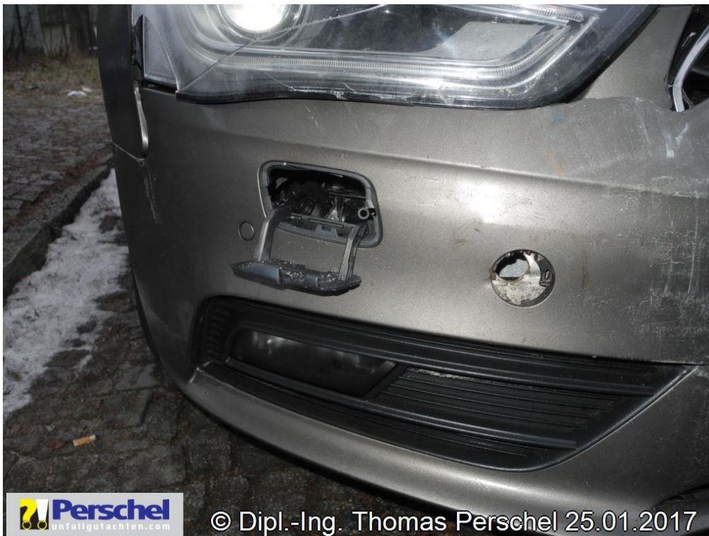
Bild 10: Waschdüse r beschädigt
