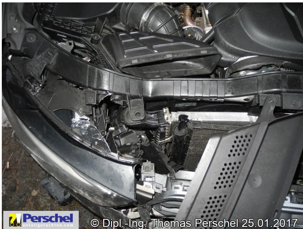
Bild 5: Scheinwerfer r vollständig zerstört
