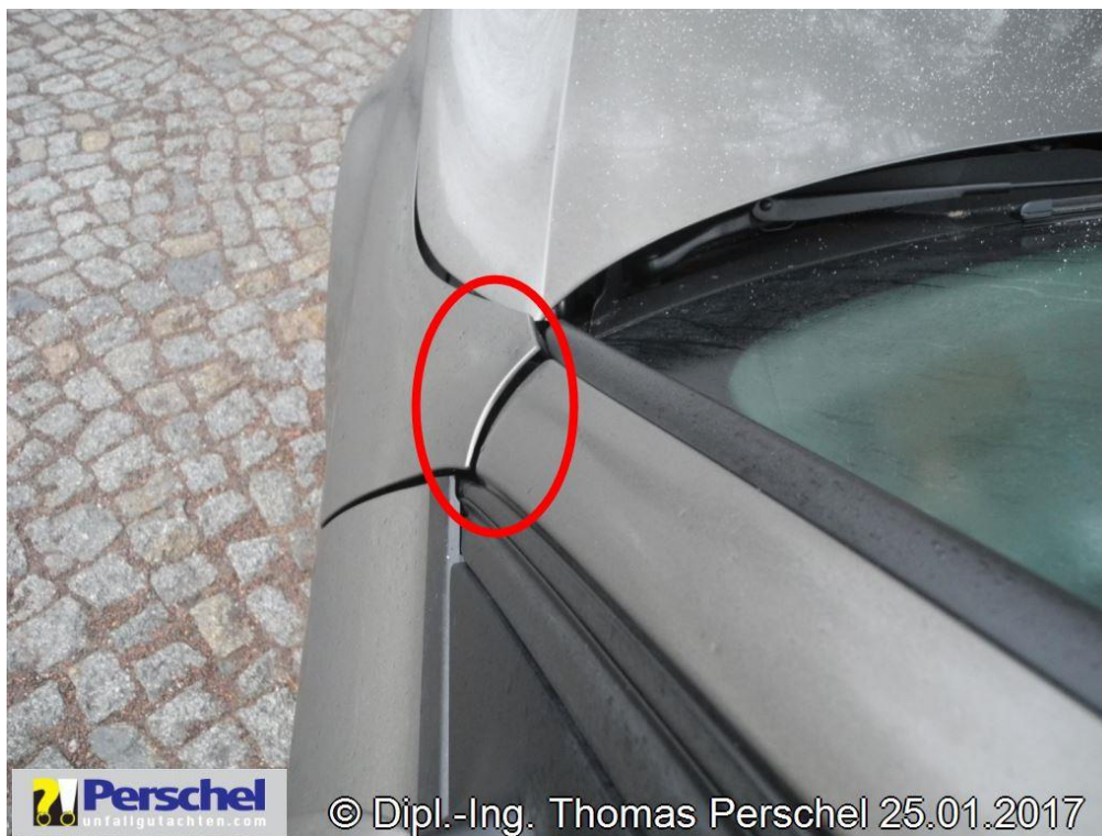
Bild 14: Kotflügel v l nicht mehr in Kontur zur A-Säule
