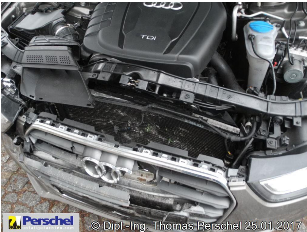
Bild 4: Grill, Kühler, Kondensator, Frontmaske beschädigt
