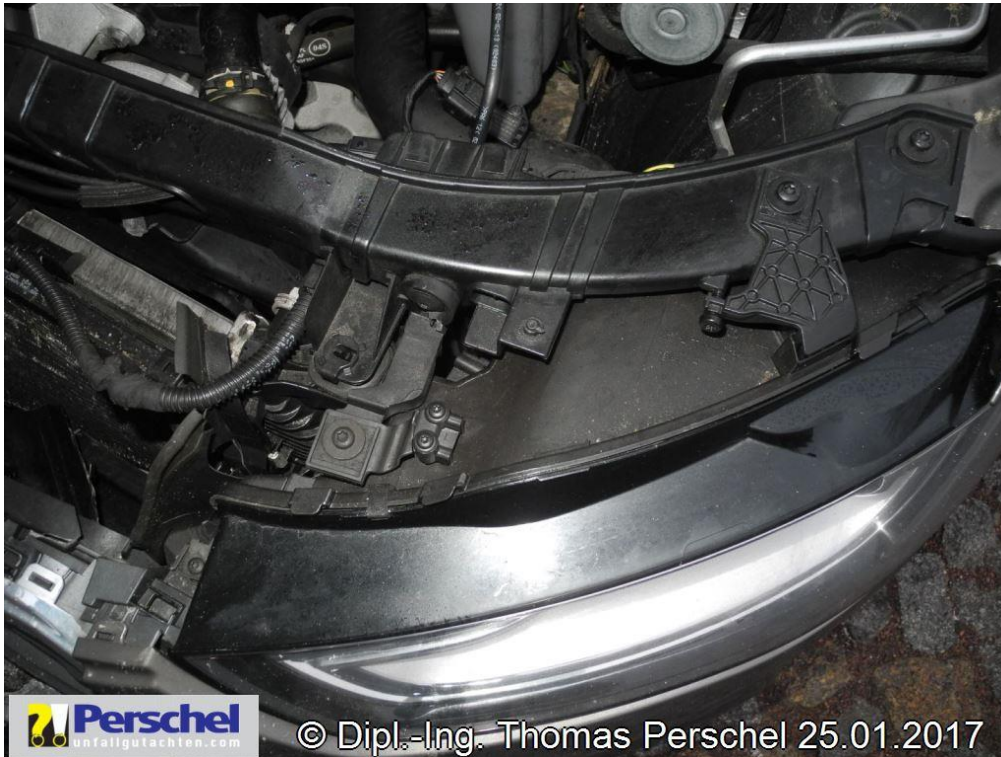
Bild 9: Scheinwerfer I ausgerissen
