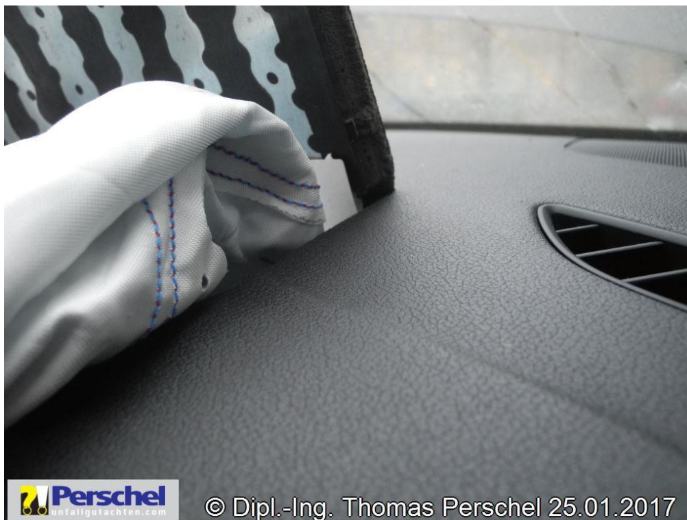
Bild 16: Beifahrerairbag ausgelöst, Armaturentafel beschädigt
