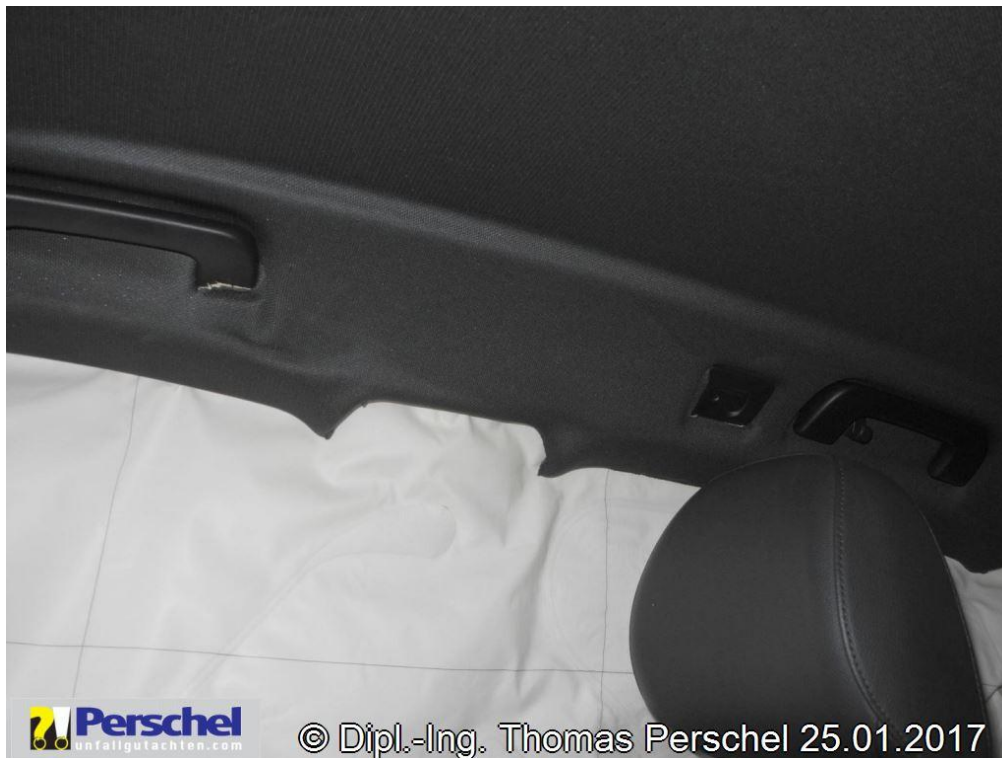
Bild 17: Kofairbag r ausgelöst, Dachverkleidung beschädigt
